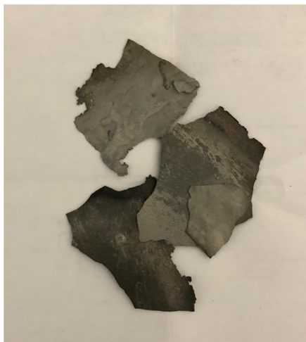
Рисунок 24 – Сплав на основе системы Nd-Fe-B, обработанный по методу стрип-кастинг.
